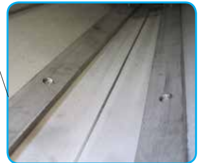
Cıvatalı aşınma barları (kanalın içten görünümü)
