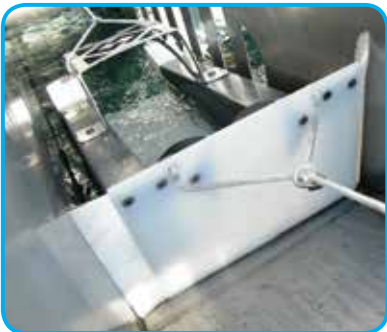
Sınırlı su çıkarımı ile kendi kendini ayarlayan yağ kazıyıcı
